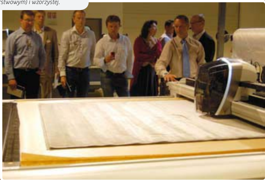
Na cutterze Vector dokonano cięcia tkaniny jednobarwnej (w trybie wielowarstwowym) i wzorzystej.
