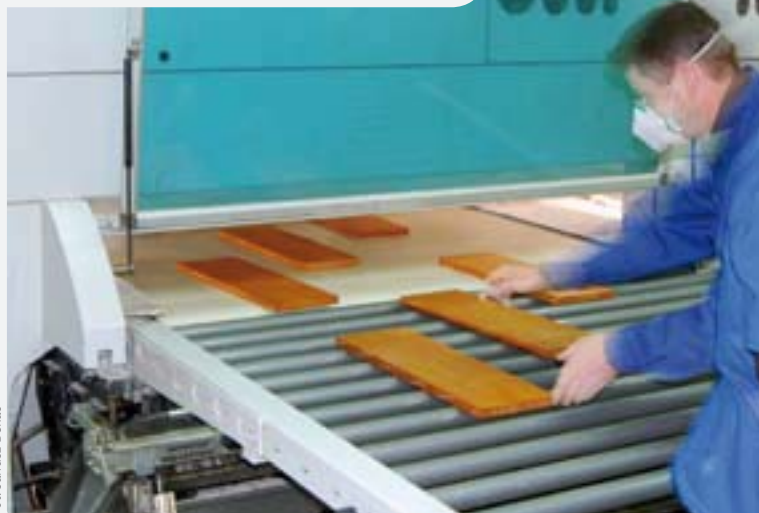
Automat natryskowy z unikalnym systemem podwójnych rolek przeciwbieżnych oraz wózkiem czyszczącym firmy Cefla.
